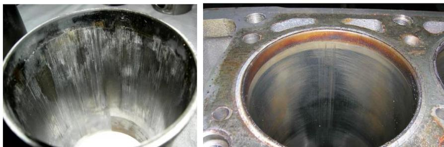
Рисунок 1 – Износы и задиры стенок гильзы цилиндров
