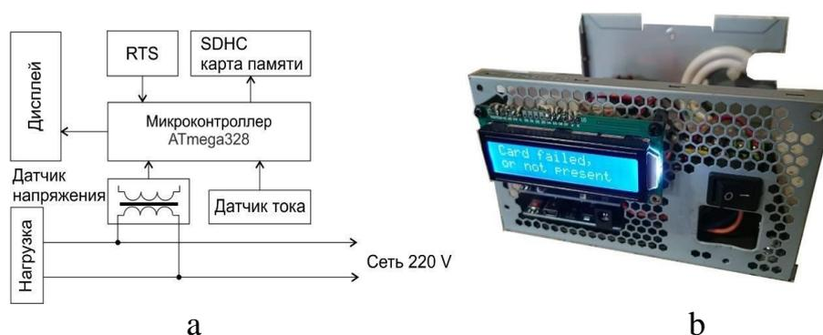
Рисунок 1. Функциональная схема (а) и внешний вид (б) устройства
