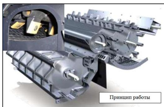
Рисунок 1 – Система обмолота и сепарации комбайна CX6090
